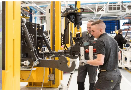
Solution IOT. Multiplication des visseuses connectées qui permettent de serrer au bon couple, au bon angle en fonction des commandes mais aussi de passer des consignes « qualité ». La formation au poste s'en trouve facilitée.
