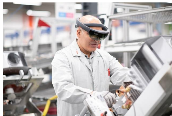
Projet Iron Men, qui est sûrement un des plus importants chez nous, nous intégrons des lunettes Hololens de Microsoft afin d'intégrer dans les lignes de production la réalité augmentée.
