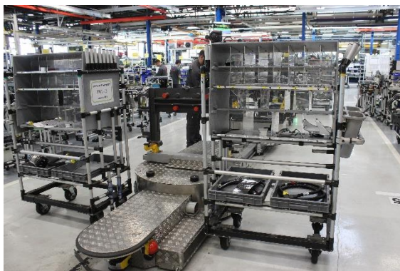
Solution Kitting Floating. Arrimé à un AGV (système de transport autoguidé), le kitting floating met à la disposition de l'opérateur les uniques pièces nécessaires à la réalisation de la commande du tracteur (moins de charge cognitive)
