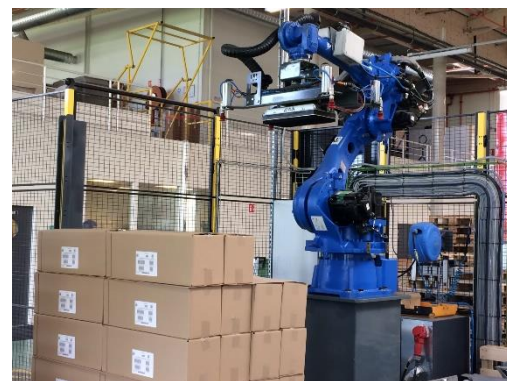
Robot de palettisation sur ligne de production haute cadence
