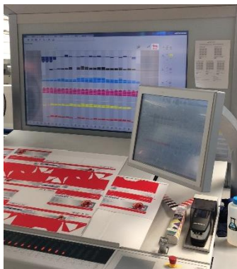
Régulation automatique de l'encrage en continu
