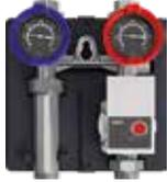
HS25/6s | <ul style="list-style-type: none"> <li>- Module pour circuit direct (sans vanne) sans régulation</li> <li>- Composé d'une tuyauterie complète, pompe haute efficacité Yonos Para RS 25/6 230V (EEI≤0,23), robinet à bille avec thermomètre 0-120 °C (retour), robinet à bille et clapet anti-thermosiphon (départ)</li> <li>- Avec boîtier isolant (EPP) en deux parties, couleur noire</li> </ul> | 7 736 601 142 | <b>891</b>   | <b>0,14</b>  |
