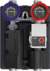
HS25/6    | <ul style="list-style-type: none"> <li>- Module pour circuit direct (sans vanne), sans régulation</li> <li>- Composé d'une tuyauterie complète, pompe haute efficacité Yonos Para RS 25/6 230V (EEI≤0,23), robinet à bille avec thermomètre 0-120 °C (retour), robinet à bille et clapet anti-thermosiphon (départ)</li> <li>- Avec boîtier isolant (EPP) en deux parties, couleur noire</li> </ul>   | 7 736 601 144 | <b>930</b>   | <b>0,14</b>  |
