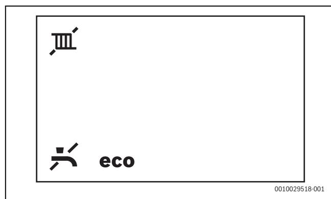
Fig. 3 Chauffage et production d'eau chaude sanitaire désactivés
